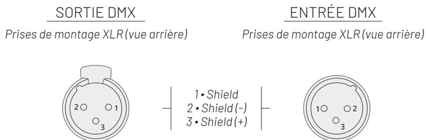
En utilisation professionnelle, la norme DMX512 impose la présence d'un «bouchon DMX» sur le dernier appareil DMX de la chaîne afin de finaliser correctement la boucle de signal. Ce bouchon est constitué d'une résistance de 120 ohms placée entre la broche 2 et la broche 3 du connecteur XLR.
